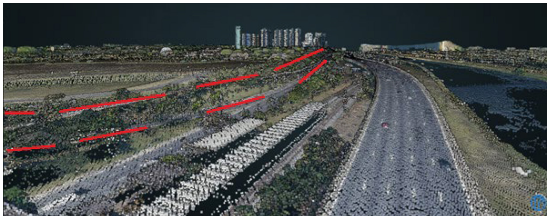
FIGURA 9 – Exemplo de levantamento topográfico feito com tecnologia LiDAR. Destaque para o talude do aterro do Parque Villa Lobos. Fonte: Plataforma GeoSampa.
