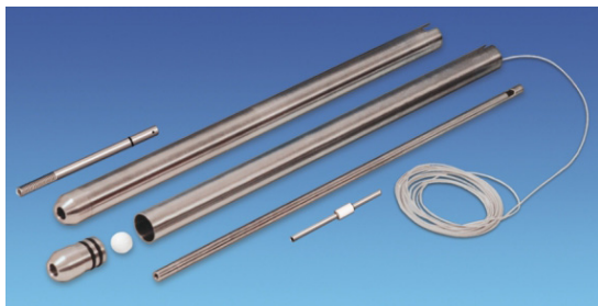
FIGURA 5 – Bailer inoxidável para amostragem em profundidade. Este tipo de amostrador permite penetração na coluna de água dos poços de monitoramento (AGSOLVE 2024).
